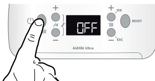
Полное выключение котла осуществляется переводом внешнего двухполюсного выключателя в положение OFF (ВЫКЛ); дисплей при этом гаснет.
