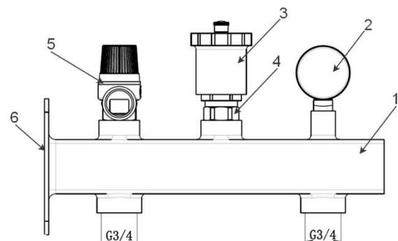
при перегреве и достижении критических отметок давления, во избежание аварийной ситуации срабатывает предохранительный клапан, справляясь излишки теплоносителя и тем самым снижая давление в системе. Входящий в состав группы безопасности манометр показывает давление в моменте:
