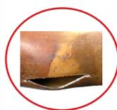
1. В период наступления осенне-весеннего сезона с ночными заморозками и зимнего периода с постоянными отрицательными температурами необходимо перекрыть вентиль крана и отсоединить шланг, иначе вода начнет замерзать вверх, по направлению к задней стенке, или "седлу" крана, а давление воды внутри трубки крана превысит предельную прочность стенок, что в конеч-
