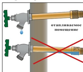
4. Монтаж крана производится с наружной стороны здания, носиком вниз, таким образом, чтобы остатки воды могли самостоятельно стечь после закрытия крана. Для этого кран монтируется под небольшим уклоном в сторону улицы – 2-5 градусов с применением зазарно-распорного клина.
