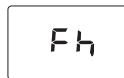
Рис. 7. Выпуск воздуха с выключенным вентилятором
