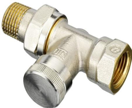
Клапаны запорные типа RLV предназначены для применения, как правило, в двухтрубных насосных системах водяного отопления с целью отключения отдельного отопительного прибора для его демонтажа или технического обслуживания без опорожнения всей системы. Не предназначены для контакта с питьевой водой в системах хозяйственно-питьевого водоснабжения.
