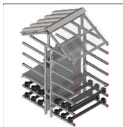
Крепление кабеля на эстакадах.
