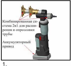
2. Насадка для расширения трубы 1. Зажимная головка вращается на 180°; повернуть до щелчка.
