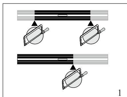
1. Сделайте разметку на лотке нужной длины. Душевой лоток может укорачиваться с одной или двух сторон.
