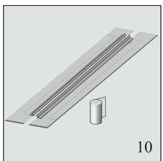
10. Нанесите монтажный клей на фланец лотка. Поверх фланца положите рулонную гидроизоляцию и установите декоративные рамки.
