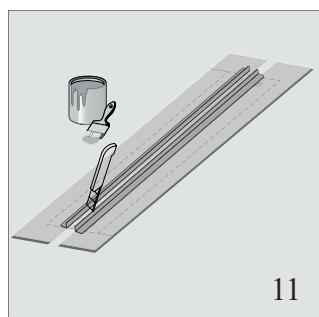
11. Нанесите несколько слоев жидкой гидроизоляции и вырежьте ножом в рулонной гидроизоляции отверстие по ширине отверстия лотка и длине декоративной рамки.
