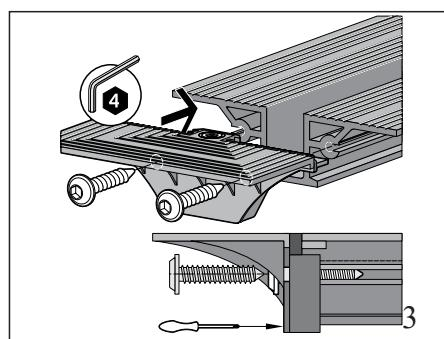
3. Зачистить от заусенцев обрезанные концы лотка и отверстия под винты. Присоедините торцевые заглушки с помощью винтов.
