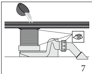
7. Подсоедините сифон к канализационной трубе, наполните слив и трубопровод водой и визуально проверьте соединения на герметичность.
