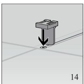
14. Вставьте опоры для накладок и подогоните их под высоту плитки.
