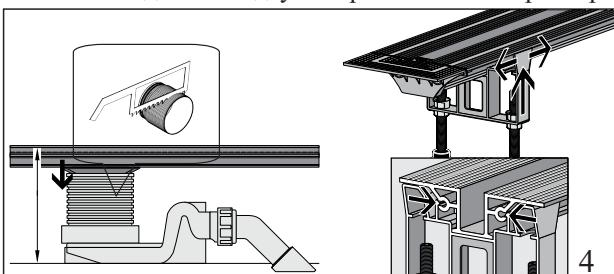
4. Определите высоту цементной стяжки, затем обрежьте сифонный патрубок до нужной высоты. Подсоедините к лотку сифон и пластиковые опоры. Опоры рекомендуется устанавливать на расстоянии не более 40 см друг от друга.
